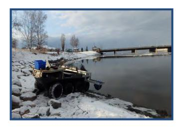
2) CIMA+ a mandaté le CIDCO pour la réalisation d'un relevé bathymétrique à l'embouchure de la rivière Rimouski en période hivernale (décembre 2014) pour la préparation de plan et devis pour la construction d'un nouveau pont. En raison de la présence de glace, le CIDCO a utilisé avec succès la bouée HydroBall™ − Pro pour réaliser le mandat.
