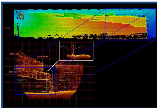
Cet axe de développement veut valoriser et mieux définir l'utilisation des technologies acoustiques et optiques (lidar) pour l'inspection d'infrastructures partiellement mouillées (murs de quai, murs de barrage et piliers de pont).
