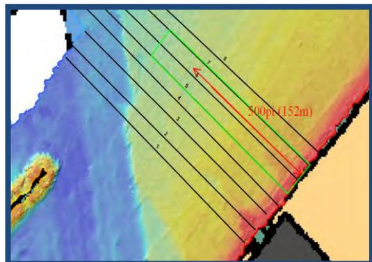
2) À la demande du CNM Évolution, le CIDCO a fait l'acquisition de données bathymétriques à la sortie du port de Rimouski afin de localiser la voiture impliquée dans l'incident du 4 juillet 2012. La vitesse d'acquisition réduite ainsi que le passage répété sur la zone à lever permettent d'atteindre une densité de sondes suffisante et ainsi garantir la localisation exacte de la voiture.
